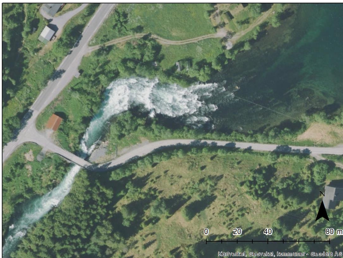
Figur 5-3. Flyfoto av utløpet. Kritisk snitt ved lav vannføring er like oppstrøms der vannet blir hvitt.
