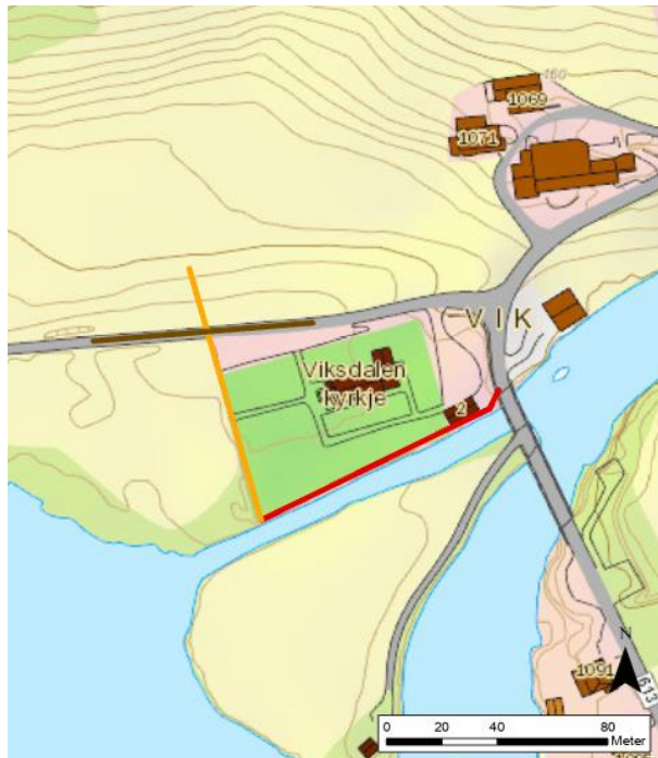
Figur 5-31: Skisse for lokal sikring av Viksdalen kirke. Rød linje representerer flommur, mens oransje linje representerer kombinert tiltak. Brun linje markerer der veien må heves.
